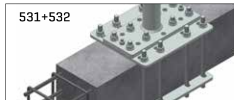
Staffaggio con base allargata, barre filettate e contropiastre, o con profili di riscontro [vedi NOTA ]
