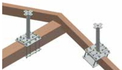
Staffaggio con base allargata, barre filettate e contropiastre, o con profili di riscontro [vedi NOTA ]
