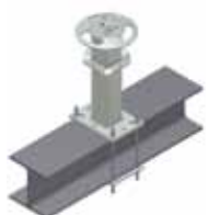
Staffaggio con barre filettate, contropiastre o profili di riscontro (vedi NOTA )
