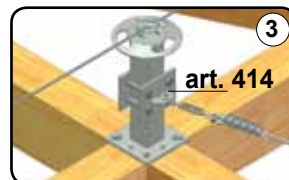
Modalità di fissaggio per ridurre i momenti flettenti sulla struttura di supporto
