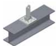
Saldatura (previa rimozione della zincatura)
